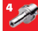
**Hinweis:** Hohe Präzision und Rundlaufgenauigkeit von  $\leq 0,03$  mm. Sichere Spannung des Werkzeugs durch mechanische Spannkraftverstärkung. Kein selbständiges Lösen der Spannung während der Bearbeitung bei Links- oder Rechtslauf, sowie bei Spindelstop. Spannen und Lösen mit Sechskantschlüssel.
