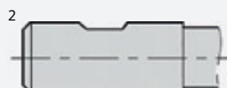
DIN 1835 B/DIN 6535 HB bis Ø 20 mm
