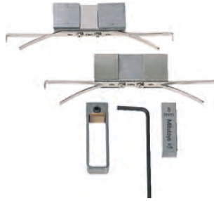
Příklad referenčního nastavení dutinoměru
