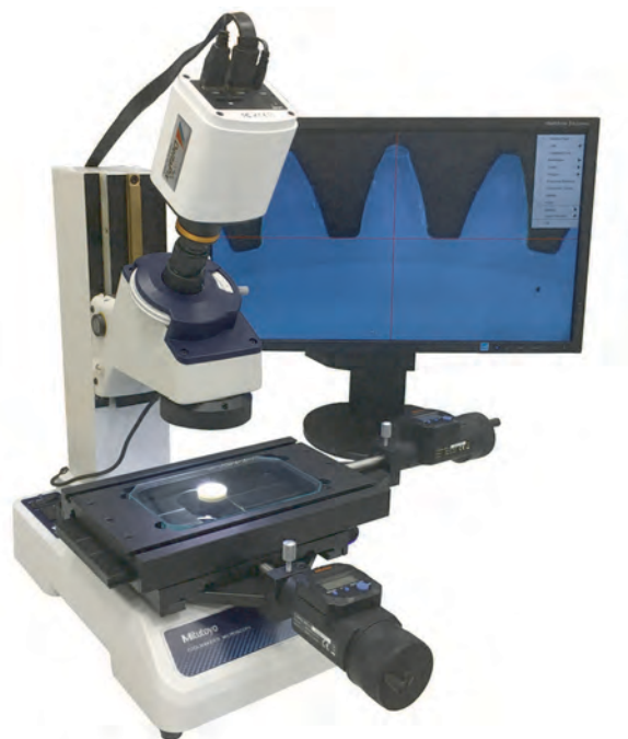
Měřicí mikroskop TM-1005B s volitelným LED prstencovým osvětlením (63AAA001), 0,37X adaptérem okuláru (63AAA060) a digitální HDMI kamerou (63AAA059)
