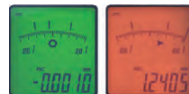
Zobrazení přepínání ze zeleného do červeného podsvícení, jestliže je překročena horní nebo dolní tolerance.
