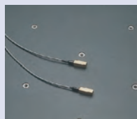
Systém teplotní kompenzace (detail teplotních čidel)
