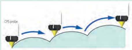
Měření skenováním s automatickým vozíčkem v ose Z.
