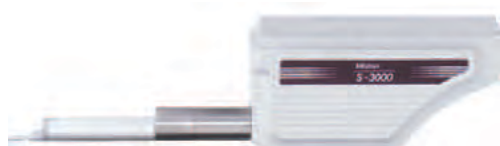
Snímací jednotka na měření drsnosti povrchu
