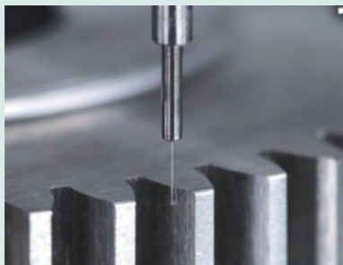
Měření ozubení pomocí MPP-Nano Modul 0,8
