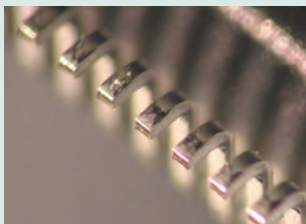
Příklad měření: Výška nožiček na QFP obalu
