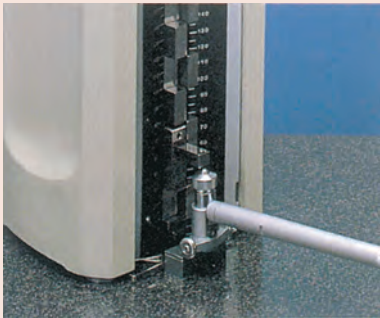
Příklad referenčního nastavení dutinoměru
