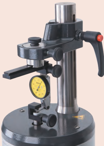
Kontrola číselníkových páčkových úchylkoměrů s volitelným příslušenstvím
