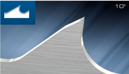
Hákový zub má pozitivní úhel čela 10°. Tento tvar zubu je vhodný zejména pro dělení plných materiálů, silnostěnných trubek a polotovárů z vyšším obsahem legovaných prvků.
