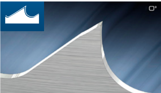
Normální zub s úhlem čela 0°. Tento tvar je vhodný pro dělení materiálu s vysokým obsahem uhlíku (např. litina), pro materiály s malým průřezem a tenkostěnné profily a prvky.
