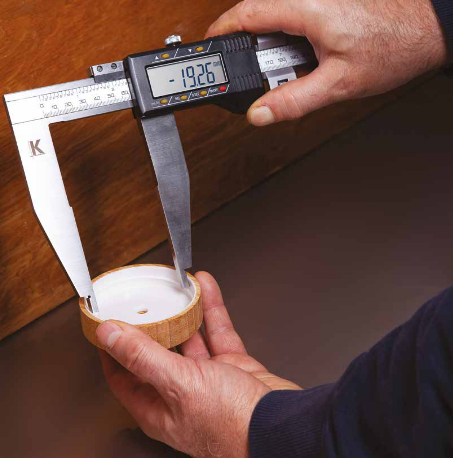
Posuvné měřítko s hloub. a vnitřním měřením, NEREZ, TOP QUALITY, ČSN 25 1238, DIN 862
